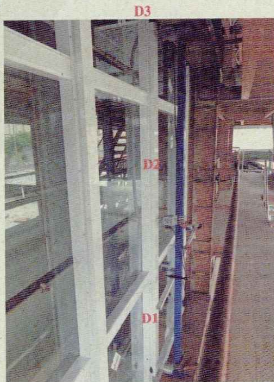
Foto nº. 02 Verificação do comportamento quando submetido a cargas uniformemente distribuídas: Posicionamento dos deflectômetros no montante.
